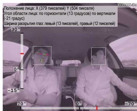
В обычных системах мониторинга камера анализирует только лицо водителя. Система Mitsubishi Electric использует широкоугольную камеру, которая благодаря гибкой установке положения контролирует как водителя, так и пассажира переднего сиденья.
