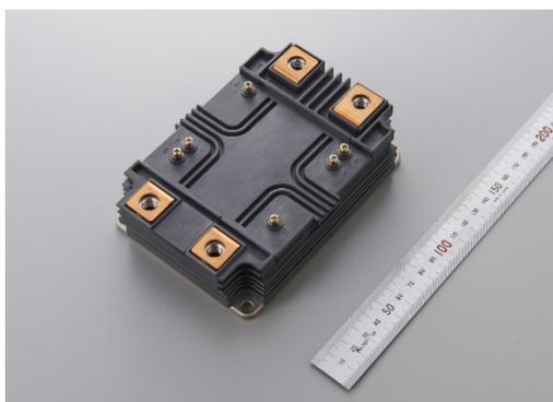
Прототип силового полупроводникового модуля Full-SiC на 6,5 кВ
