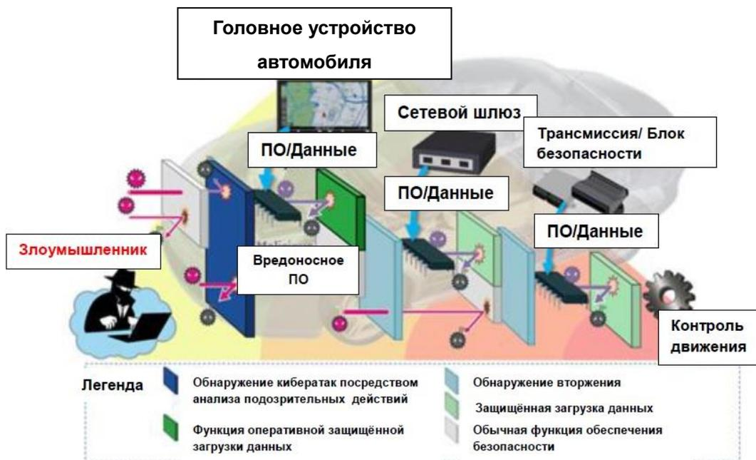
Многоуровневая технология киберзащиты для подключенных автомобилей
