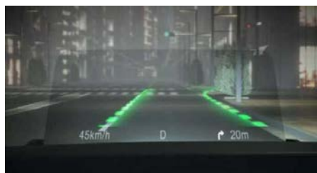
Рис. 3. Проекционный дисплей с дополненной реальностью
