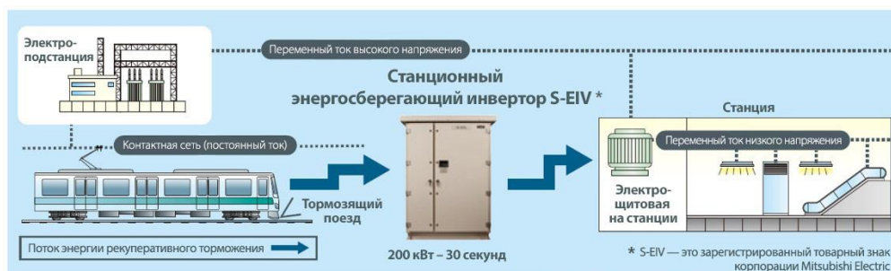
Структура системы с новыми интегрированными S-EIV на 400 В
