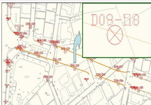
Пример 1. Повышение точности цифровой карты путем наложения на неё данных о позиционировании дорожных объектов
