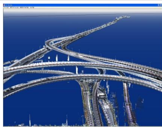
Пример 2. Обмер дорожной развязки в 3D при помощи стандартного лазерного сканера с совмещением цветными изображениями, полученных с камеры
