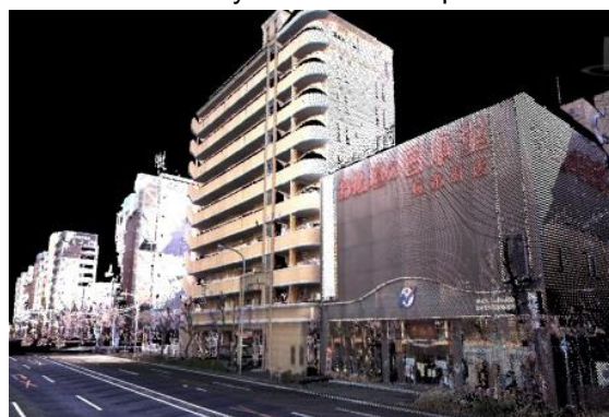
Пример 4. Подробный обмер внешних сторон здания с помощью дополнительного лазерного сканера большого радиуса действия или лазера с высокой плотностью излучения
